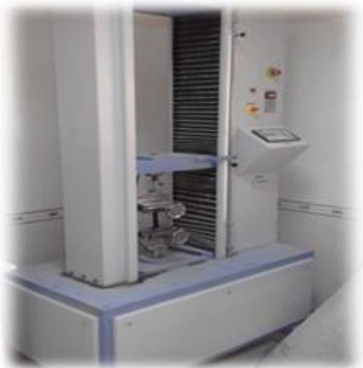
شكل رقم(2) جهاز قياس قوة الشد والتمدد
